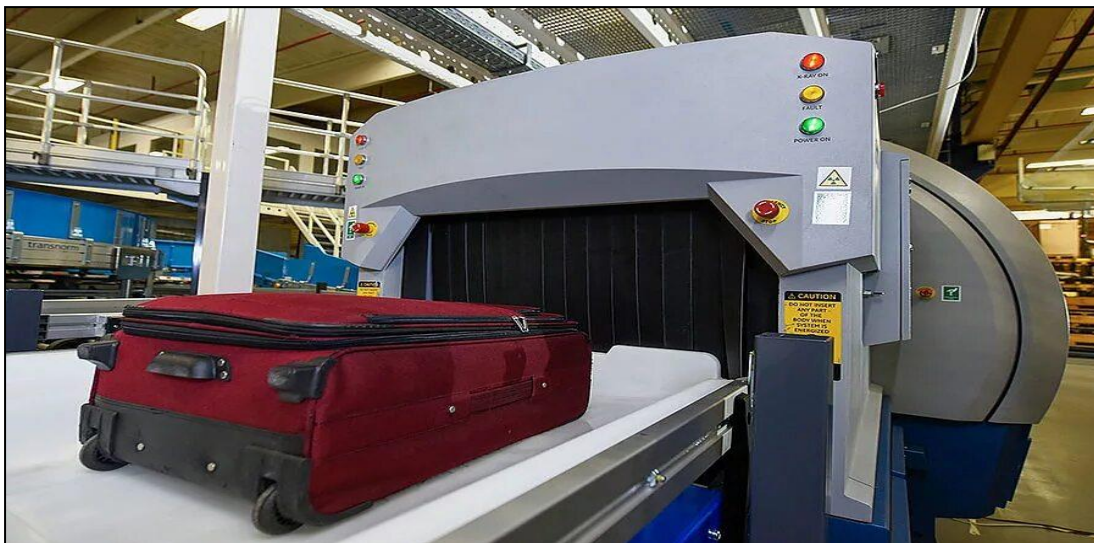
Рисунок 4. Процесс досмотра багажа томографом в аэропорту «Платов»
